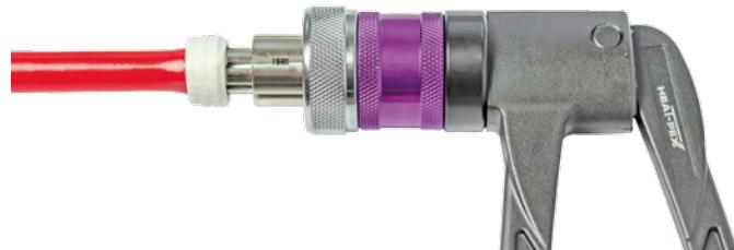
За допомогою інструменту з відповідною насадкою розширте трубу з фітингом.
