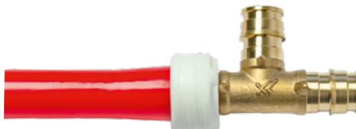
Якомога швидше вставте фітинг у трубу та утримуйте в такому стані декілька секунд, поки труба з гільзою не обтисне фітинг. Між кільцем та упором на фітингу не має бути ніякого проміжку. Фітинг має входити в трубу з невеликим спротивом. Якщо фітинг входить без спротиву, це означає, що труба була занадто розширенна.
