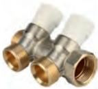
CP 452/FR | 2-ходовий простий модульний колектор з автоматичним вирівнюванням і запірними клапанами G 1.<br>Підключення для мідних і пластикових труб G 3/4 EK | шт.        | 18,05            |
